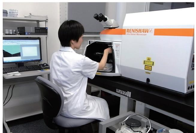
図 22：顕微ラマン分光装置を用いたフォトルミネッセンス分析
