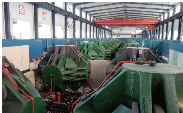
図 9：中国大手製造会社の高圧合成装置
