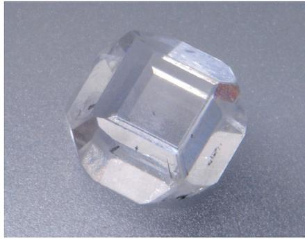
図 13：HPHT 合成原石（5.62 ct）
