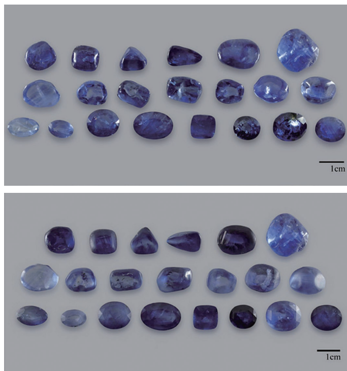
上：HT+P 処理の前の、すでに従来型の加熱を施されたサファイア。 下：同じ石を、HT+P 処理した後。従来型の加熱と同様、出発材料の化学組成の違いによって結果はまちまちである。Choi et al., 2018 より。写真：P. Ounorn
