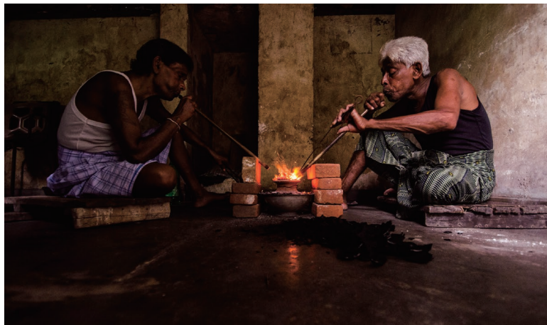
スリランカのラトゥナプラでブローパイプにより加熱する古来の技法を行う処理業者。およそ紀元 1045 年に Beruni が記述したように、この技法で到達する温度は金の融点（1064℃）を超える。Hughes et al., 2014 より。 写真：Wimon Manorotkul, 2012
