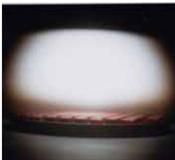
CVD合成ダイヤモンドが作られているところ。プラズマ化したガスは白い雲のように見えている。
