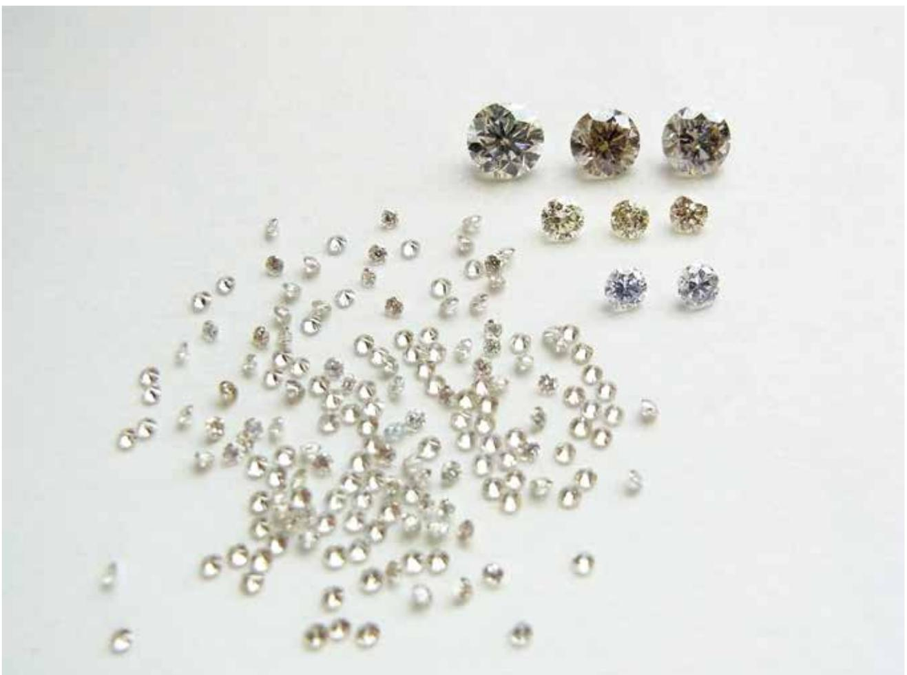
写真1：研究用に調査した中国製と思われる HPHT 合成ダイヤモンド。最大は 0.52ct
