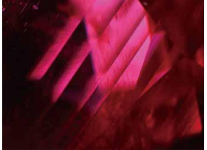
写真6：ブラインド状双晶面：変形双晶の一種で、しばしばモザンビーク産ルビーにも見られる
