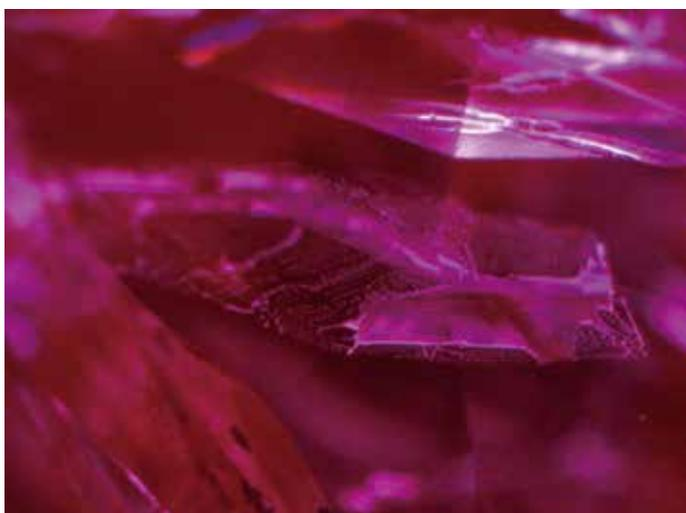
写真11：加熱により癒着した液体インクルージョン
