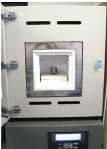
図 2：加熱処理に用いたマッフル炉 (ADVANTEC 製 FUM312DA)
