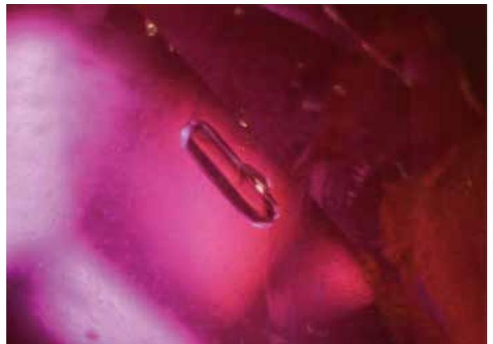
写真4：柱状の結晶（パーガサイト）インクルージョン：パーガサイトは角閃石の一種で、モザンビーク産ルビーの母岩である角閃岩の主要構成鉱物である
