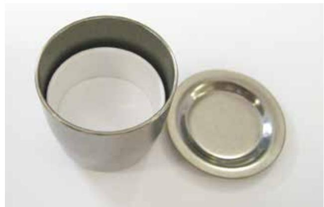
図 3：加熱処理に用いたるつぼ (ジルコニウムるつぼの中にムライト質磁製るつぼを配置)
