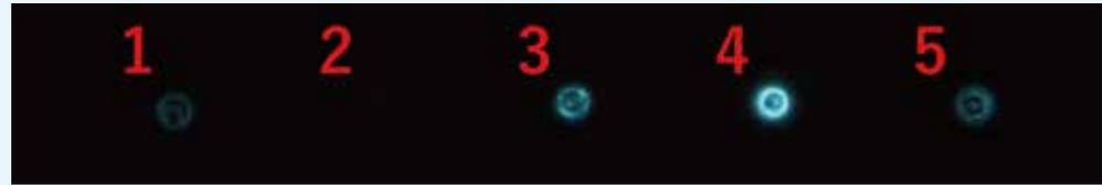
図 3. グループ A に  $50.0 \times 10^{15} \text{e}^-/\text{cm}^2$  の電子線を照射した後の地色と燐光画像
