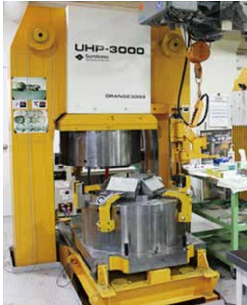
図 2 マルチアンビル高圧発生装置。
