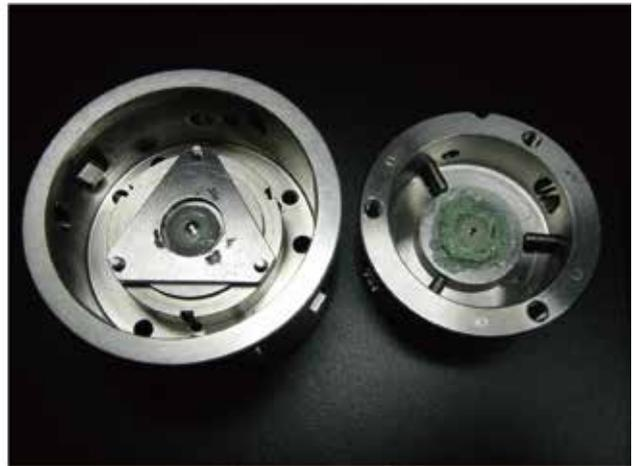
図 3 研究室で使用しているダイヤモンドアンビルセル。外形は約 70 mm。(左) セルの外観。3 本のネジで加圧していく。(右) セルの内部。上下に 1 対のダイヤモンドアンビルが装着されている
