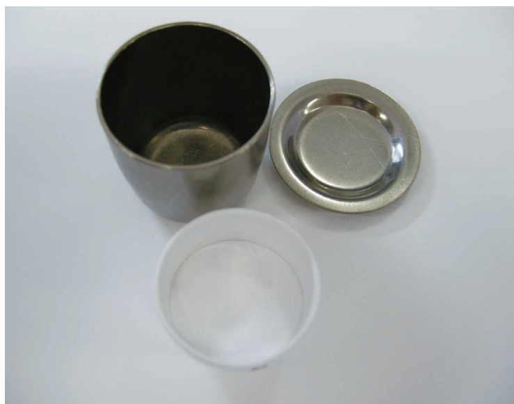
図 3：加熱に用いたるつぼ。上部がジルコニウムるつぼ とその蓋、下部がムライト製磁性るつぼ
