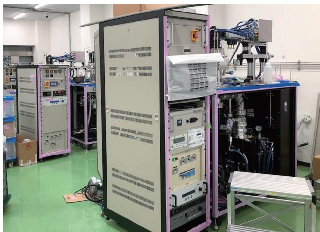
Fig. 7 マイクロ波 CVD 装置：
