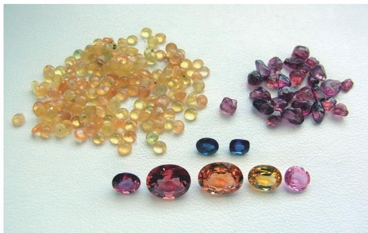
図 2. さまざまな色の Be 拡散加熱処理コランダム
