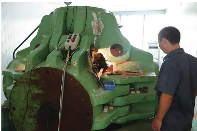
Fig. 6 中国で使用されている HPHT 合成装置
