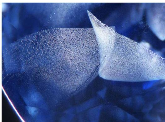
写真-10：液体（フィンガー・プリント）インクルージョン
