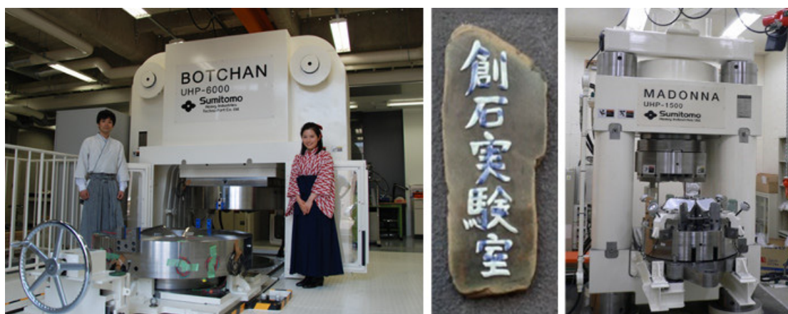
図9. 創石実験室に設置された大型超高压合成装置BOTCHAN(左)と、超高压発生装置MADONNA(右)。
