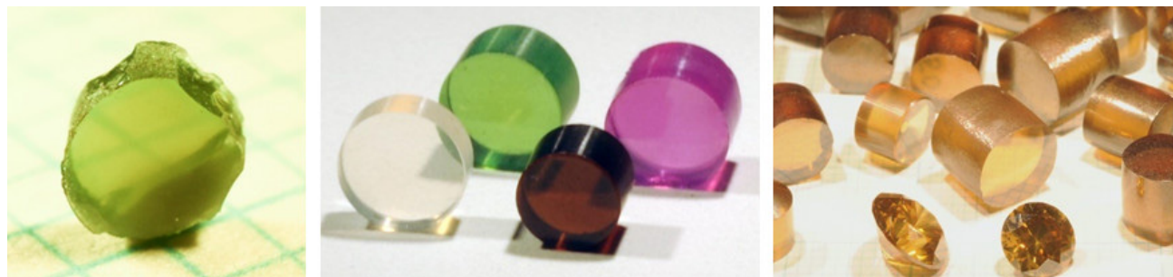
図10. 超高压合成法により得られたヒスイ(左: Alに対してCrを1モル%置換、直径約2 mm)、様々な組成のナノ多結晶ガーネット(中: 直径約4 mm)、ナノ多結晶ダイヤモンド(右: 直径約6-8 mm)。
