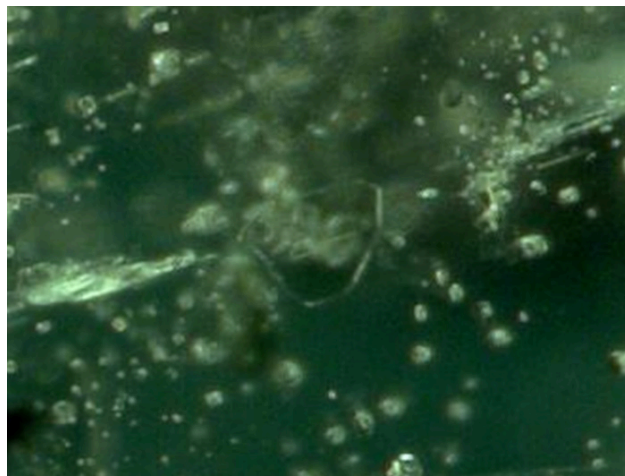
図20 疑似六角形をする褐色がかった雲母インクルージョン。視野0.8 mm。
