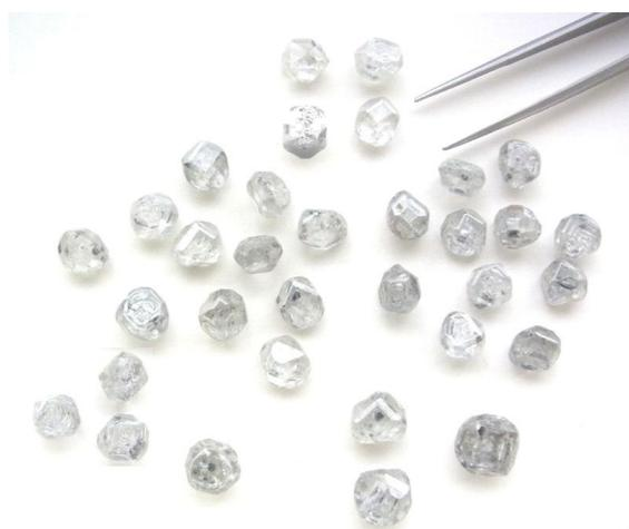
Fig. 1: 中国製の無色系HPHT法合成ダイヤモンド原石
