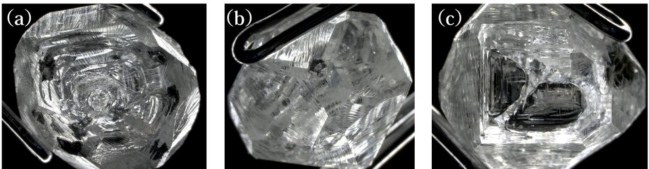
Fig.9 (a):種結晶の近傍付近に見られる金属inc.、(b):分域境界付近に見られる金属inc.、(c):種結晶と対角にある{100}面領域に見られる金属inc.
