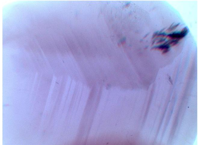
図13. ヨウ化メチレンに浸液することで観察できるスリランカ産アレキサンドライトの曲がったセクターバウンダリー
