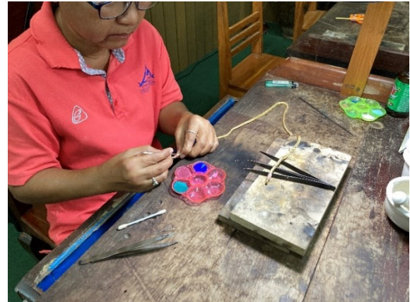
手作業で金のチェーンを編み上げている様子
