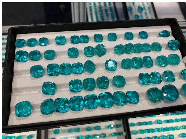
Lab Grown Paraiba として売られている YAG と再結晶石として売られている(おそらくベルヌイ法)合成サファイア
